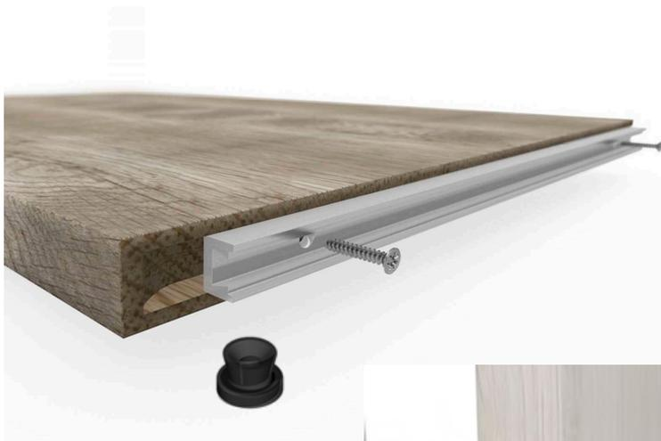
Die KEILSCHIENE wird stirnseitig in die genuteten Fachböden eingesetzt und nimmt form- und kraftschlüssig die am Gegenstück aufgeschraubten Keilhülsen auf. Werden die Fächböden nicht durchgefräst, entsteht nach vorne hin eine unsichtbare Möbelverbindung. Bei Massivholzböden wirkt die Keilverbinderschiene ausserdem als aussteifende, unsichtbare Gratleiste.
